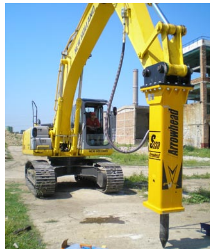
Jeden z najcięższych młotów serii S – model S230 na koparce gąsienicowej New Holland
