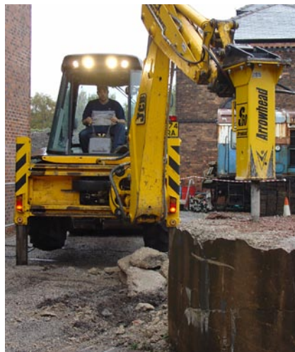
Arrowhead S60 to młot o ciężarze 330 kg do zastosowania na koparkoładówkach
